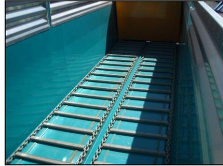
Figure 24 : Fond mouvant à quatre chaînes.
