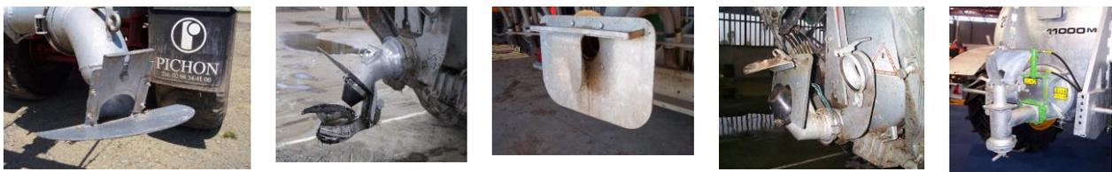
Figure 10 : Exemples de buse-palette (de gauche à droite : buse à palette, buse de précision, buse à jet rabattu, buse à palette inversée, buse pivotante).
