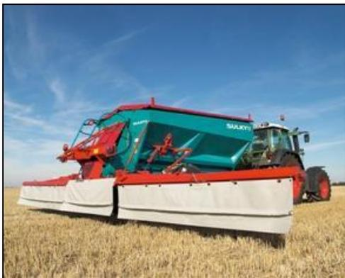
Figure 34 : Dispositif d'épandage de produits pulvérulents à table d'épandage.
