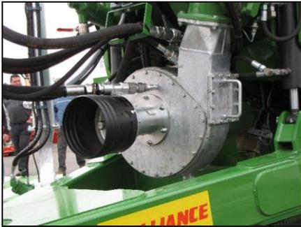
Figure 4 : Pompe centrifuge à l'avant.
