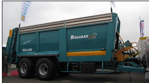
Figure 22 : Epandeur à caisse large.
