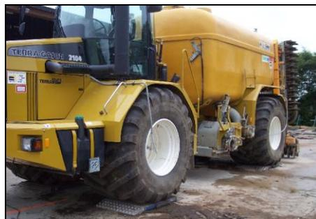
Figure 6 : Epandeur à lisier automoteur à pompe volumétrique.
