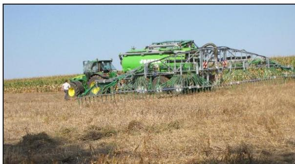
Figure 13 : Rampes à pendillards.
