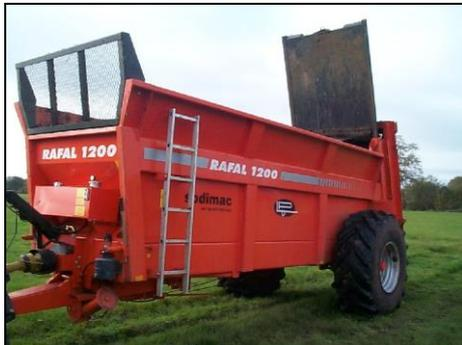
Figure 21 : Epandeur à caisse étroite.
