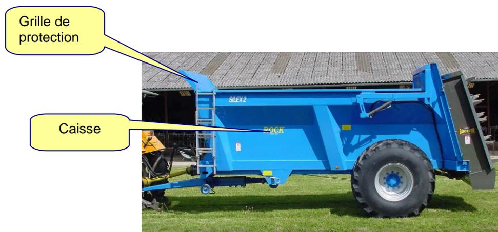
Figure 20 : Epandeur à fumier.
