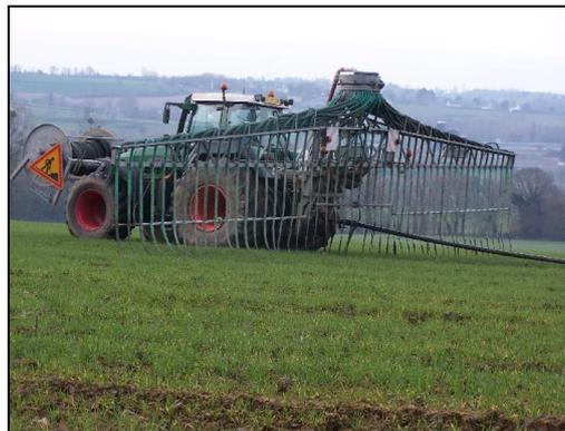
Figure 15 : Epandeur sans tonne.
