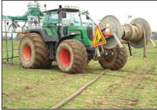
Figure 9 : Pneumatiques basse pression montés sur tracteur.
