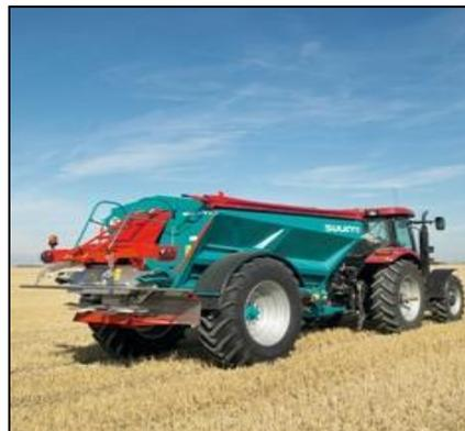
Figure 35 : Dispositif d'épandage de produits pulvérulents en rampe à vis.
