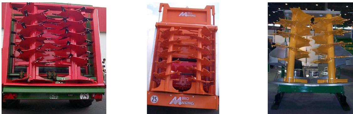
Figure 25 : Hémrissons verticaux (de gauche  droite : sur caisse large, sur caisse troite, hémrissons non parallles).
