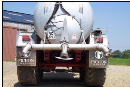
Figure 11 : Dispositif tri-buses.
