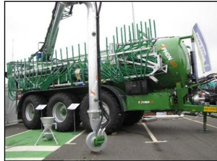
Figure 5 : Pompe centrifuge en bout de bras.
