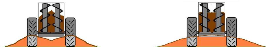
Figure 30 : Répartition en M (gauche) et répartition en dôme (droite), obtenues avec des épandeurs à fumier.
