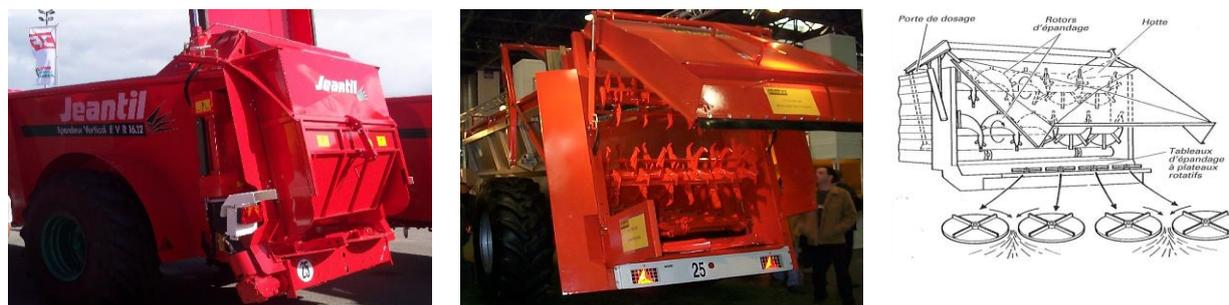
Figure 26 : Dispositifs de tables d'pandage (de gauche  droite : hotte arrire ferme, hotte arrire ouverte, schma du dispositif interne).
