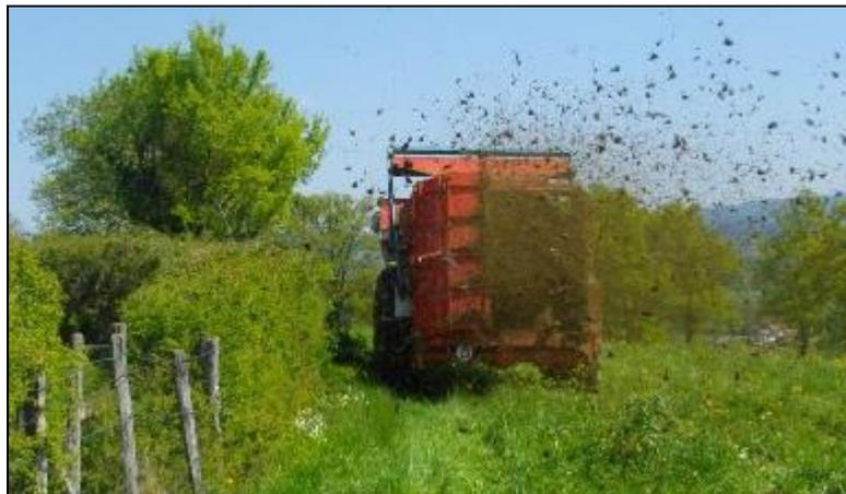
Figure 31 : Epandeur à fumier muni d'un volet de bordure.
