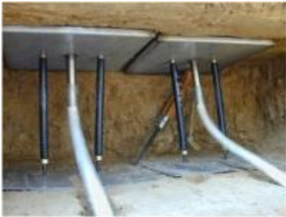
Figure 4: Lysimètres ouverts avec mèche en fibre de verre ; source : INRA
