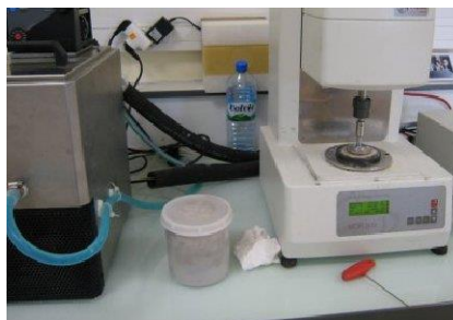
Figure 16 : Rhéomètre avec une géométrie plan/plan.
