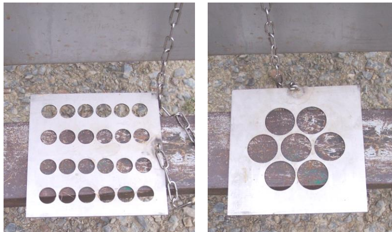
Figure 6 : Exemple de grille pour la boîte à bouchage. Grille n°2 (à gauche) et grille n°4 (à droite).
