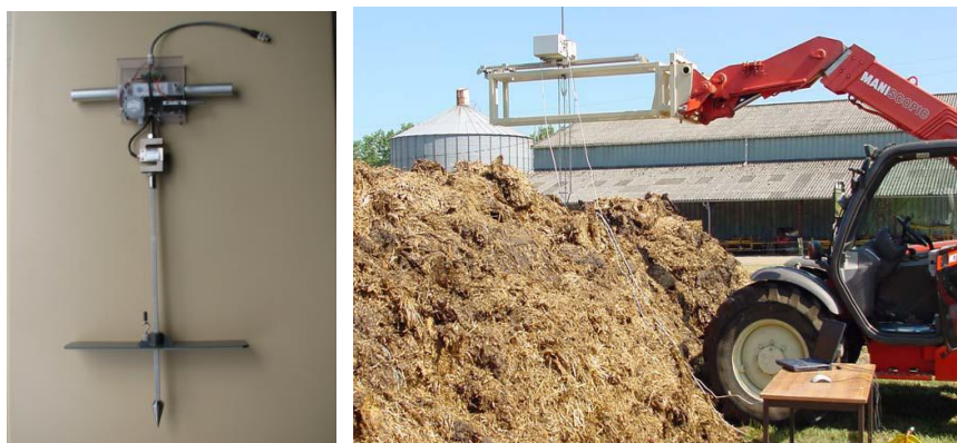
Figure 9 : Pénétrètres électroniques, manuel (gauche) et automatique (droite). Exemple de dimensions pour le pénétrètre manuel : diamètre maximum de la pointe 3 cm, longueur 6 cm.
