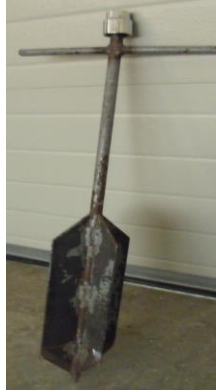
Figure 12 : Scissomètre. Exemple de dimensions : pales disposées en croix de 5 cm de large pour 34,5 cm de haut
