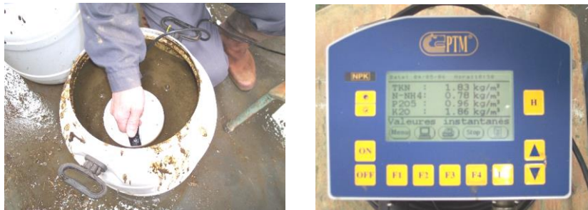
Figure 21 : La sonde est plongée partiellement dans le lisier (à gauche). L'écran du calculateur fournit les valeurs des composantes : azote, phosphore, potassium (à droite).
