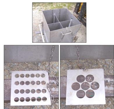
Figure 2 : Boite à bouchage et ses grilles pour la caractérisation du lisier.
