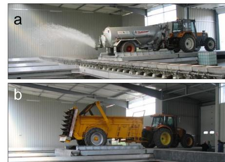
Figure 5 : Tonne à lisier et épandeur à fumier lors d'expérimentations sur banc d'essais (CemOB, Irstea).
