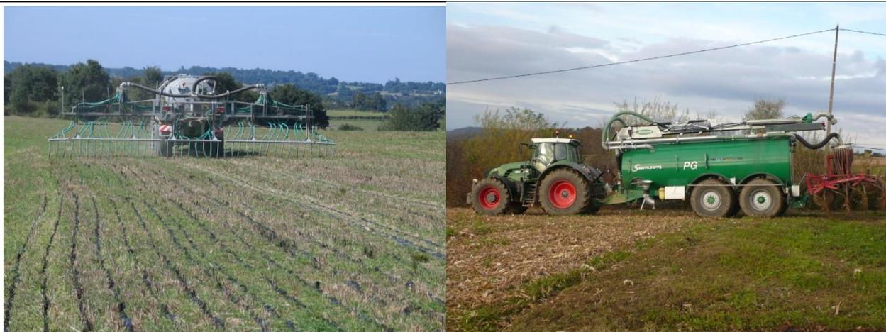
Figure 1 : Epandage à l'aide d'un dispositif de type pendillard (gauche, CA Vendée)
